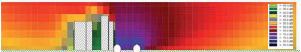
Figura 5.3: Disipación energética del ruido: sección transversal de la intensidad sonora que producen dos carriles de tráfico rodado en zona semiurbana. Fuente: BCNecologia.
